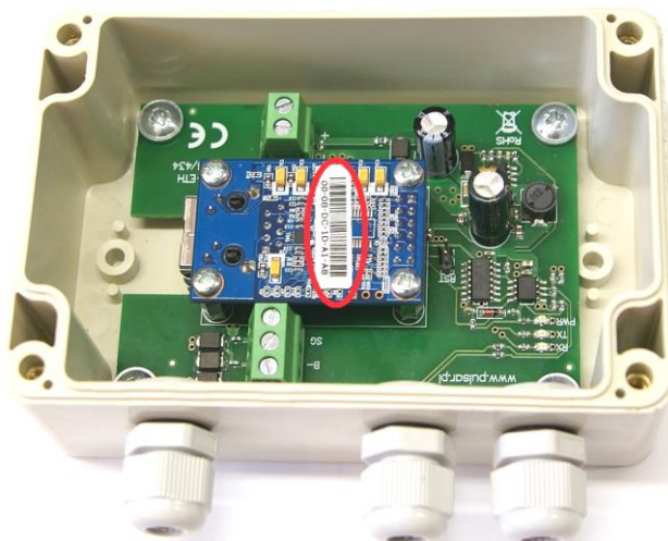
Rys. 6. Umieszczenie adresu MAC na module interfejsu INTRE.
